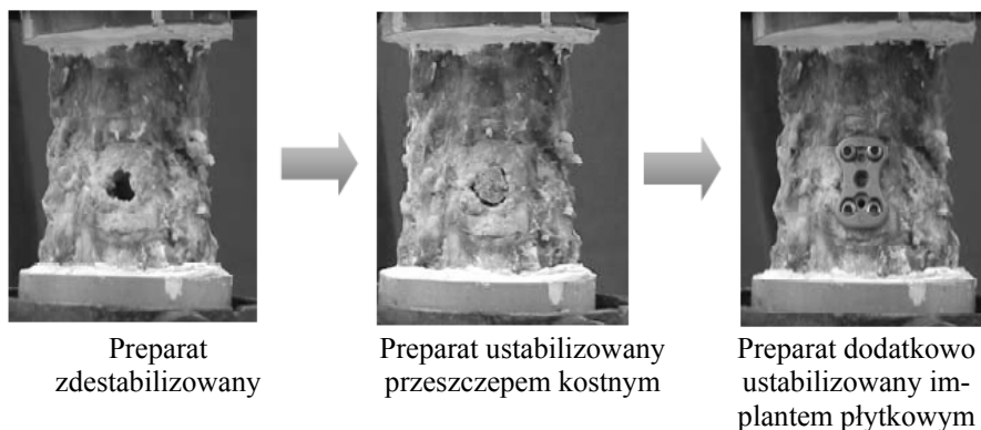
Rys. 1. Schemat przygotowania preparatu do badań
