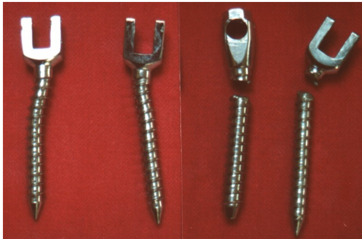
Rys. 10. Przykłady uszkodzenia śrub transpedicularnych wywołane nieprawidłową instrumentacją.
